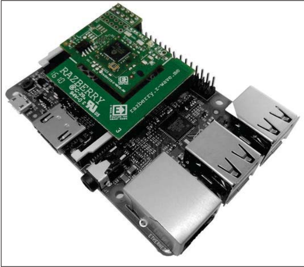
Рис. 1. Плата із трансивером Z-Wave для GPIO інтерфейсу Raspberry Pi
